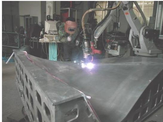
图 13-51 利用激光-MIG 复合热源焊接修复大型航空模具工装 (哈焊所)
