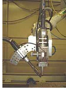
图 13-17 简单机械连接的复合焊枪
