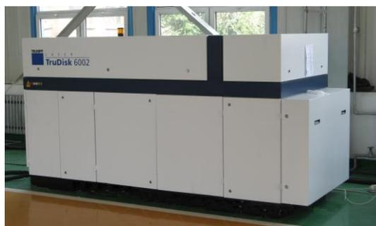
图 13-11 6kW 碟形激光器
