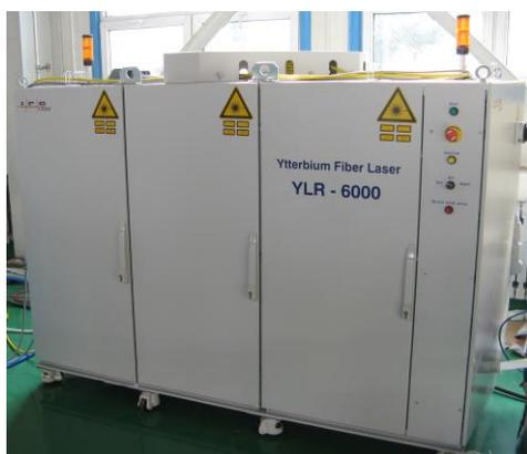
图 13-10 6kW 光纤激光器
