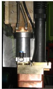
图 13-18 哈尔滨焊接研究所的一体化复合焊枪
