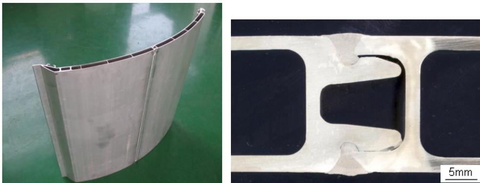
图 13-54 铝合金型材激光-MIG 复合热源焊缝成形 (哈焊所)
