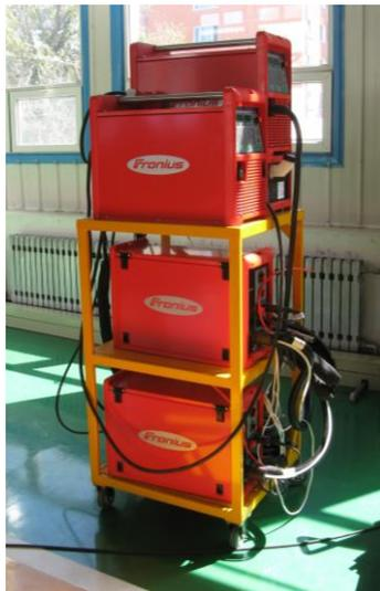
图13-15 数字化双丝MIG焊接电源
