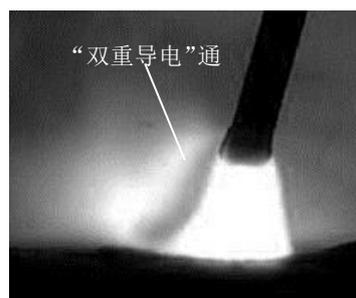
图 13-24 激光-熔化极电弧复合热源焊接过程中的“双重导电”现象
