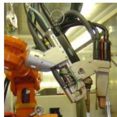
图 13-22 激光-MIG 复合热源-双丝 MIG 焊枪
