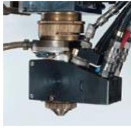
图 13-16 激光-MIG 同轴复合焊枪
