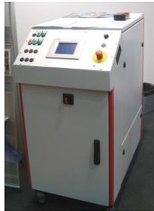
图 13-12 半导体激光器主体控制柜（Laserline）
