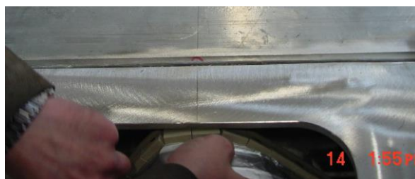
图 24-59 陶瓷衬垫粘接示意图
