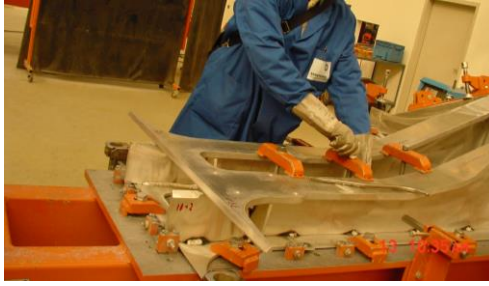
图 24-28 下盖板安装示意图
