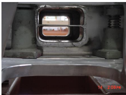
图 24—60 螺旋支架控制焊接错口示意图
