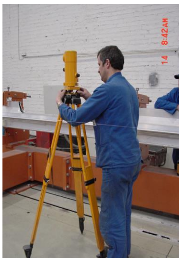
图 24—53 水平测量仪安装示意图
