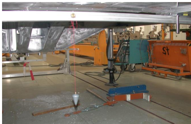
图 24—87 线坠安装示意图
