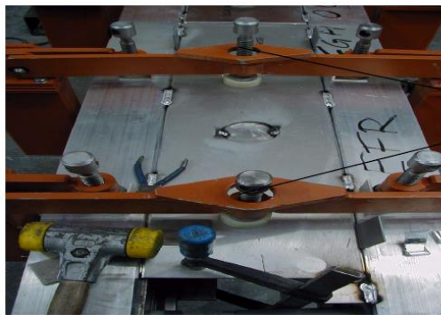
图 24-11 下盖板压紧示意图
