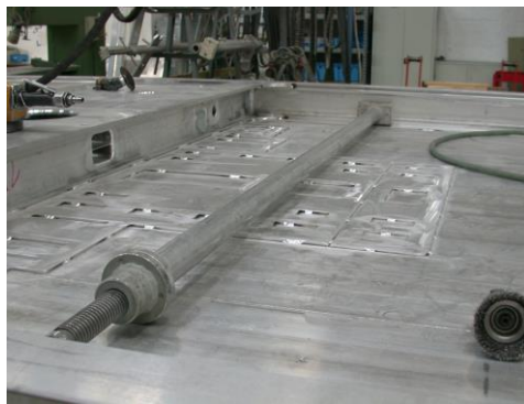
图 24—72 枕内顶针安装示意图
