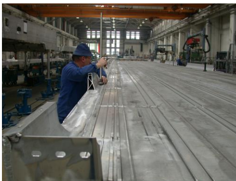
图 24—81 底架边梁上平面高度差检测示意图
