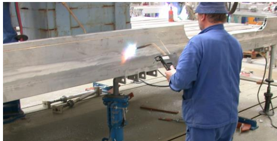
图 24—83 底架调修示意图
