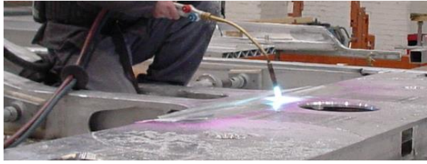
图 24—76 对接焊缝预热示意图
