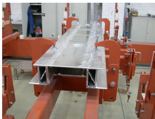
图 24-46 枕梁压紧示意图
