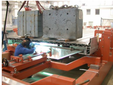
图 24-62 地板安装、点固示意图
