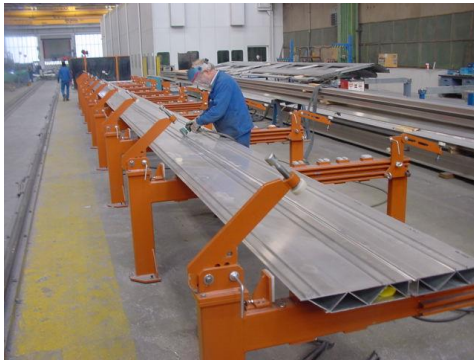
图 24—36 焊缝打磨示意图
