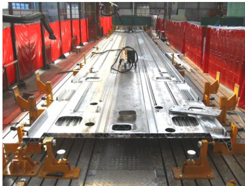
图 24—99 底架上平面零件组焊
