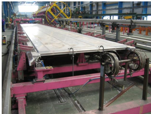
图 24-42 气动卡具固定地板两侧型材的自动化作业模式
