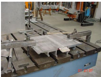
图 24-14 车钩座组成焊接示意图
