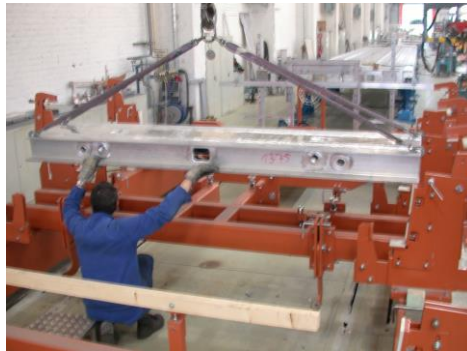
图 24-45 枕梁吊装示意图
