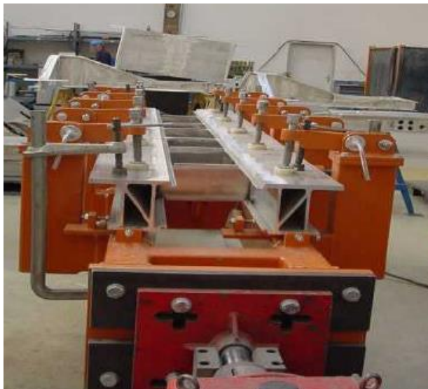
图 24-6 枕梁横梁组对示意图
