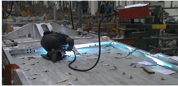
图 24—77 小件点固焊接示意图
