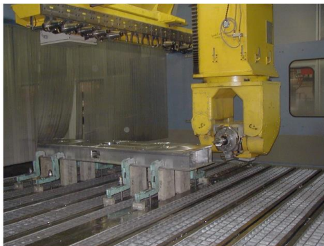
图 24-12 枕梁加工示意图
