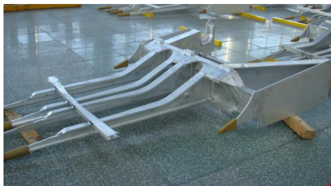
图 24—96 牵引梁结构示意图
