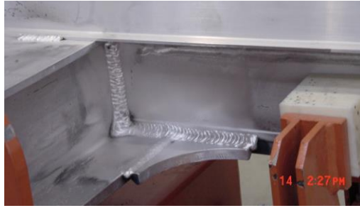
图 24-61 框架焊缝位置示意图
