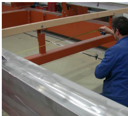
图 24—52 检测边梁是否对称的测量示意图
