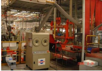
图 32-4 移动式焊烟净化器
