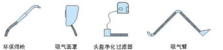
图 32-3 常用的烟尘捕捉方式
